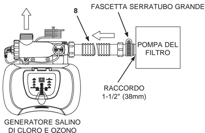
1. Montare il tubo di collegamento (8) allo sbocco esterno della pompa a filtro con una fascetta serratubo grande. Serrare fermamente.
