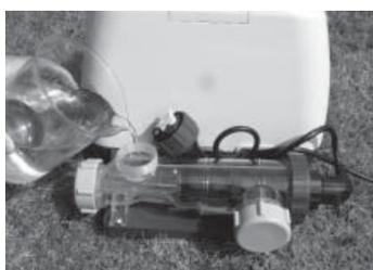
6. Aprire un lato del coperchio della cellula (11), rimuovere l'aceto e smaltirlo. Collegare la pompa che va dalla piscina alla cellula. Sciacquare l'alloggiamento della cella elettrolitica con acqua corrente.
