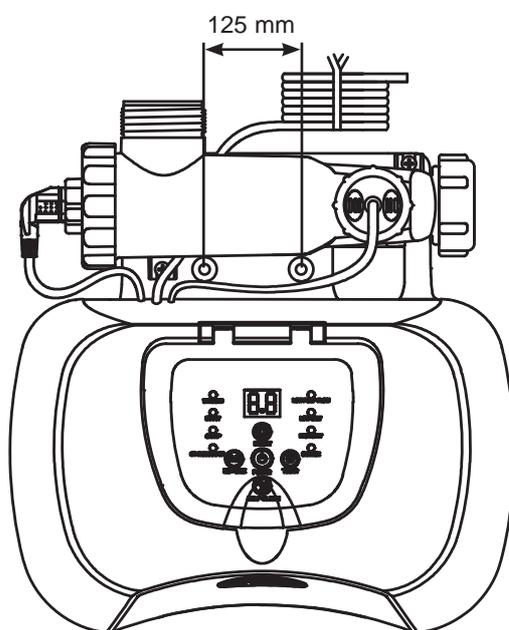
1. I fori di montaggio hanno un diametro di 6,4 mm e distano l'uno dall'altro 125 mm.
