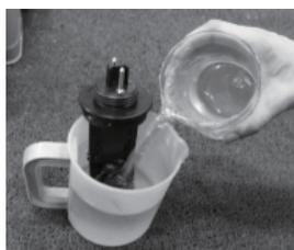
6. Inverser les étapes 3 et 4 pour replacer l'électrode de titane (5).
