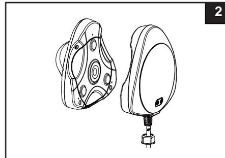
2. Posizionare il trasmettitore (2) sulla parte esterna delle pareti della piscina e la luce (1) sulla parte interna della parete, quella sommersa dall'acqua. Assicurarsi che le aste magnetiche del trasmettitore siano allineate correttamente con le aste magnetiche della luce. **Vedi disegni (3).**
