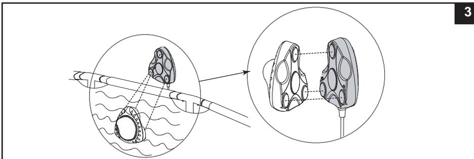
3. Regolare la posizione della luce spostando il trasmettitore lateralmente e/o verticalmente.
