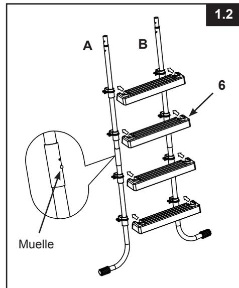
**IMPORTANTE:** Asegúrese de que las barandas (patas de la escalera) se encuentran correctamente ensambladas y totalmente encajadas. Revise que los clavos han encajado antes de continuar con el siguiente paso. Asegúrese que las barandas en J miran hacia afuera antes de instalar los escalones.
